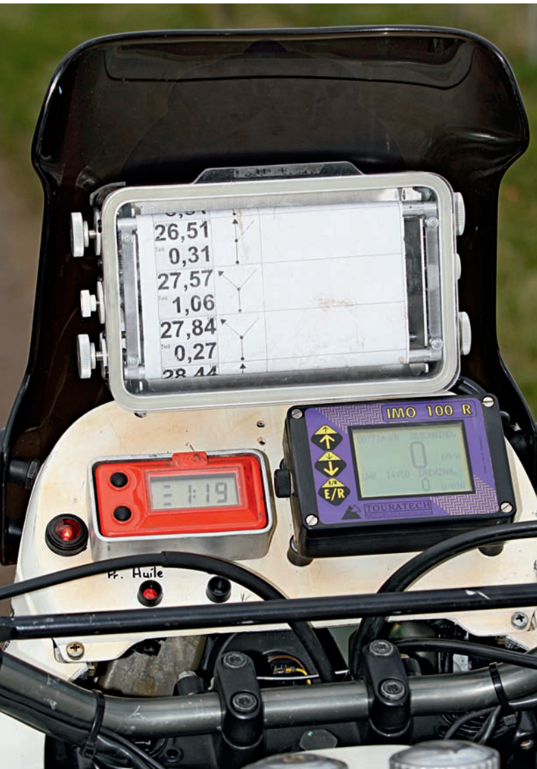
Zeitzeugen: IMO-Tacho und Tripmaster sind original, das fehlende Roadbook fand sich bei Touratech im Fundus
