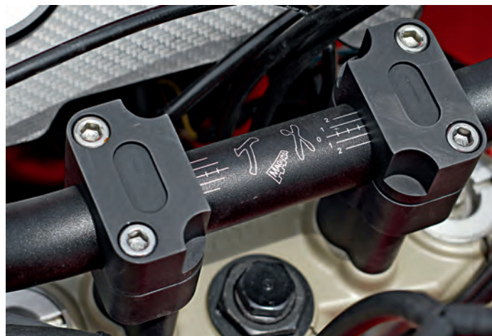
Maßarbeit: bewährter Geländelenker und Halterungen von Magura
