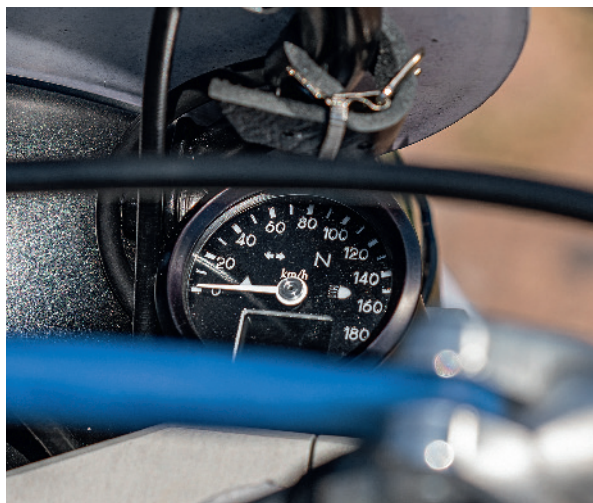
Zwar nicht streng original, aber trotzdem schön klassisch: Gasgriff von Venhill nach Originalvorlage von Magura, Lenkerschalter von der Strich-Fünf-Baureihe, kleiner Zeigertacho mit integriertem LCD-Fensterchen von MMB. Derlei Details fallen erst auf den zweiten Blick auf
